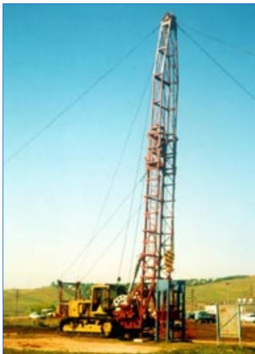
Агрегат предназначен для производства спуско-подъемных работ при текущем ремонте скважин, не оборудованных вышечными сооружениями, производства тартальных работ, для чистки песчаных пробок желонкой и возбуждения скважин поршневанием (свабированием).
